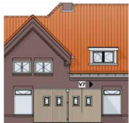
Gevels uitbouw met houten gevelbekleding
